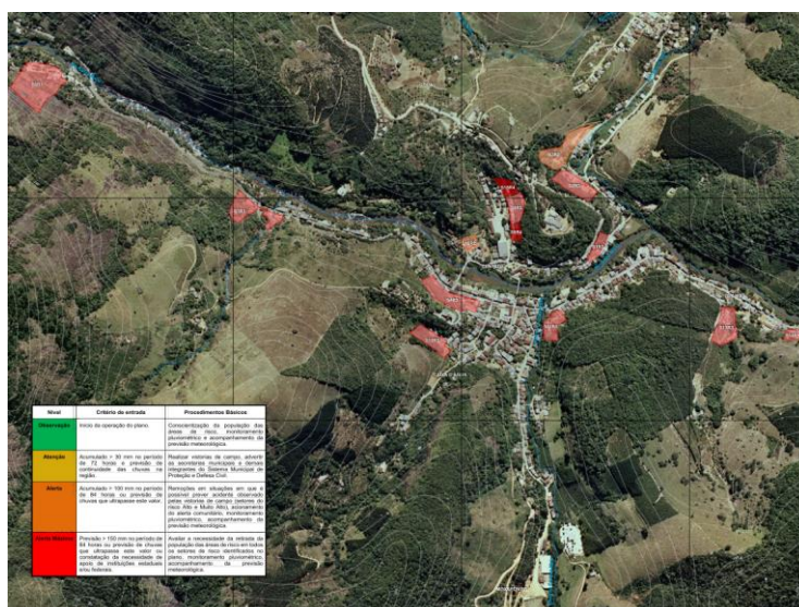
Figura 12: Exemplo de áreas de rios de deslizamento mapeadas. Fonte: Plano Municipal de Redução de Risco do município.
