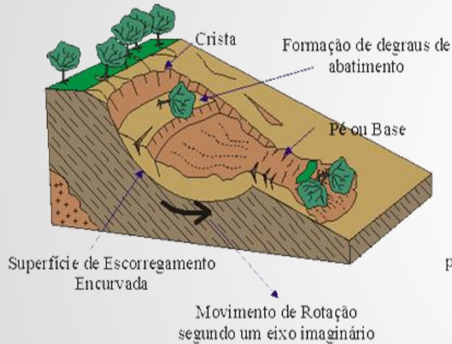
Escorregamentos Circulares (Rotacionais)
