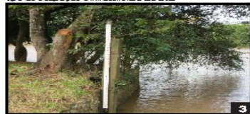
Barra de monitoramento do nível do rio dos Sinos.
