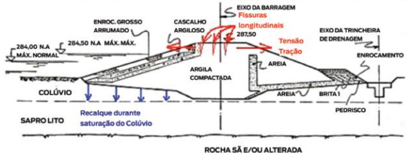
Figura 7. Fissuras longitudinais na crista de barragem de terra no Brasil, causadas pelos recalques de camada de solo coluvionar de basalto, na fundação.
