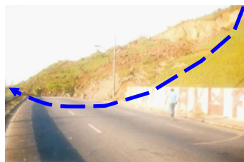
Figura 3.10 – Escorregamento circular ou rotacional.
