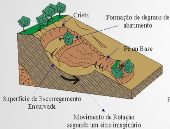
Escorregamentos Circulares (Rotacionais)
