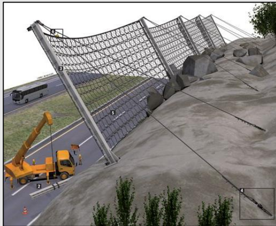
Atenuadores – barreira de proteção Créditos: Infraestrutura urbana. Fonte: http://infraestruturaurbana.pini.com.br
