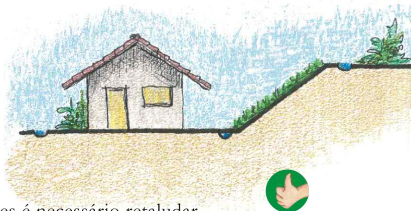
Às vezes é necessário retaludar, ou seja, fazer novos cortes ou aterros para diminuir a inclinação da barreira e reduzir o risco.
