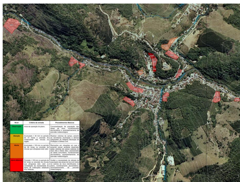
Figura 13: Exemplo de áreas de risco de deslizamento mapeadas no Plano Municipal de Redução de Risco.
