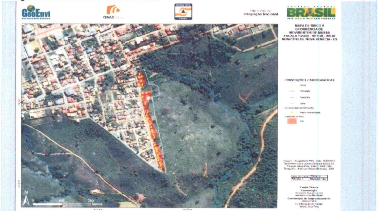
Descrição SR-02 – Bairro Alvorada: erosão superficial com perda de sustentação do talude e das moradias. Risco: movimentação de massa e enxurradas.
