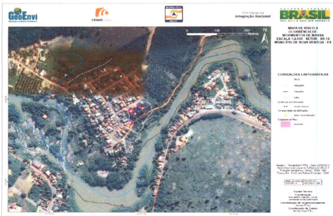
Descrição SR-12 - Bairro Fátima: erosão taludes de cortes subverticais, solo arenoargiloso. Risco: movimento de massas.
