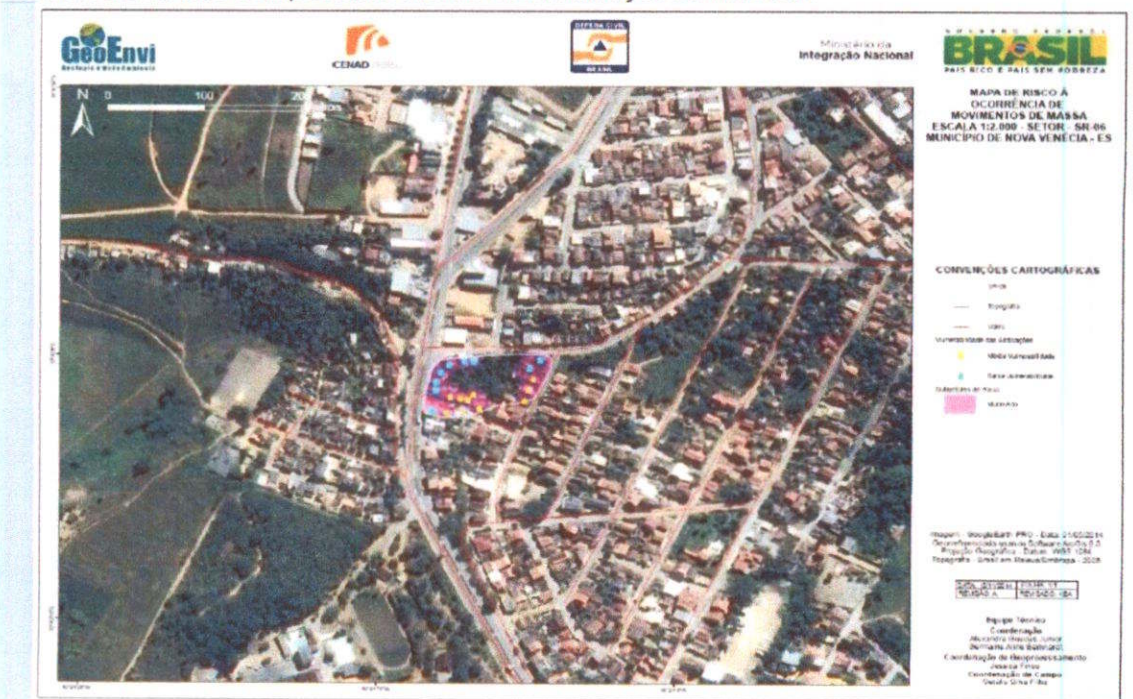
Descrição SR-06 – Yolanda: erosão superficial em solo arenoargiloso de declividade acentuada, falha na drenagem de águas pluviais. Risco: Movimentação de massas.
