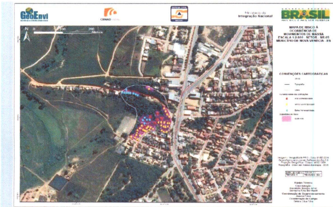
Descrição SR-05 – Bairro Betânia: ravinamento em cabeceira de drenagem de anfiteatro aterrada com material não compactado. Risco: movimentação de massas.
