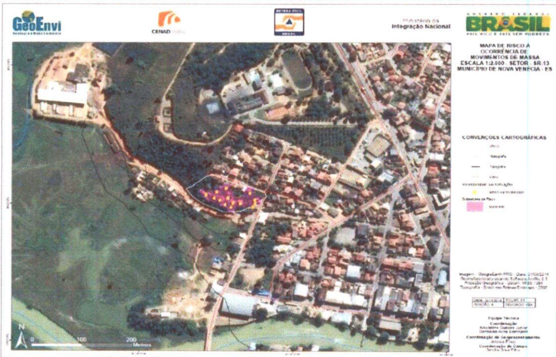
Descrição SR-13 - Bairro Beira Rio: erosão em taludes de cortes subverticais. Risco: movimento de massas.
