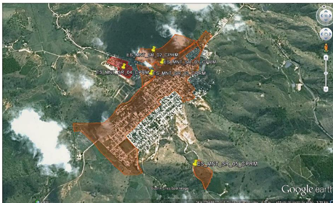
Figura 1: Setores de risco alto e muito alto na região central do Município de Mantenópolis. Em laranja os setores de risco alto e em vermelho os setores de risco muito alto, totalizando 5 setores.
