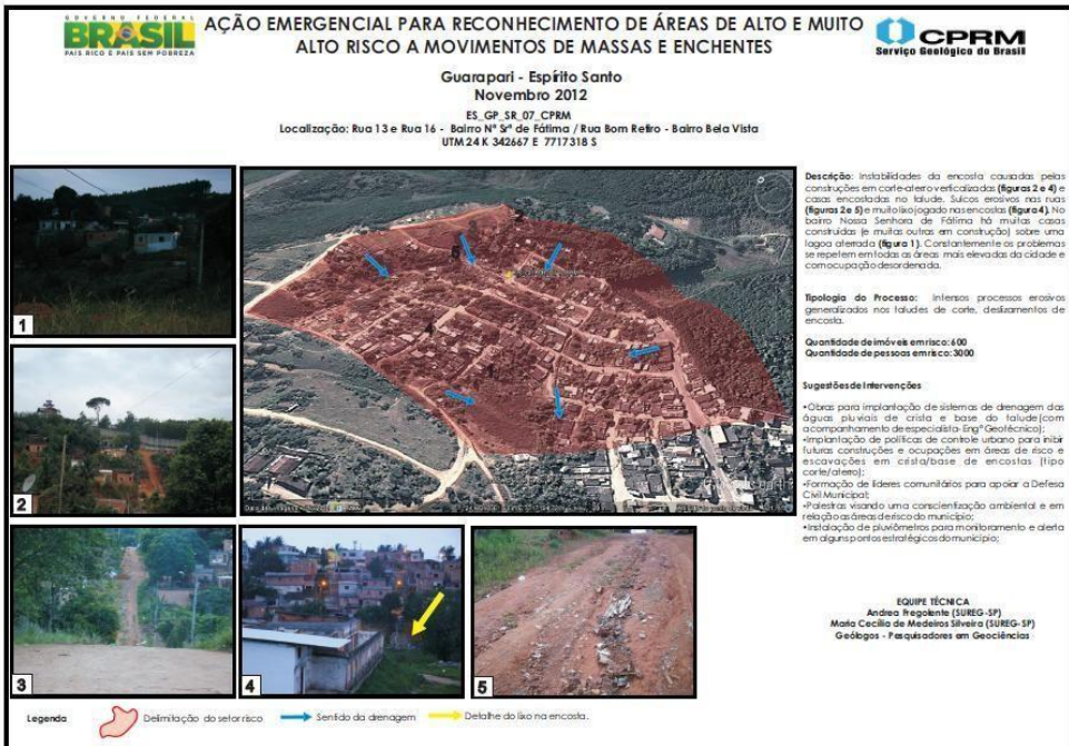
Figura 12: Setorização de área de risco geológico. Fonte: CPRM 2012
