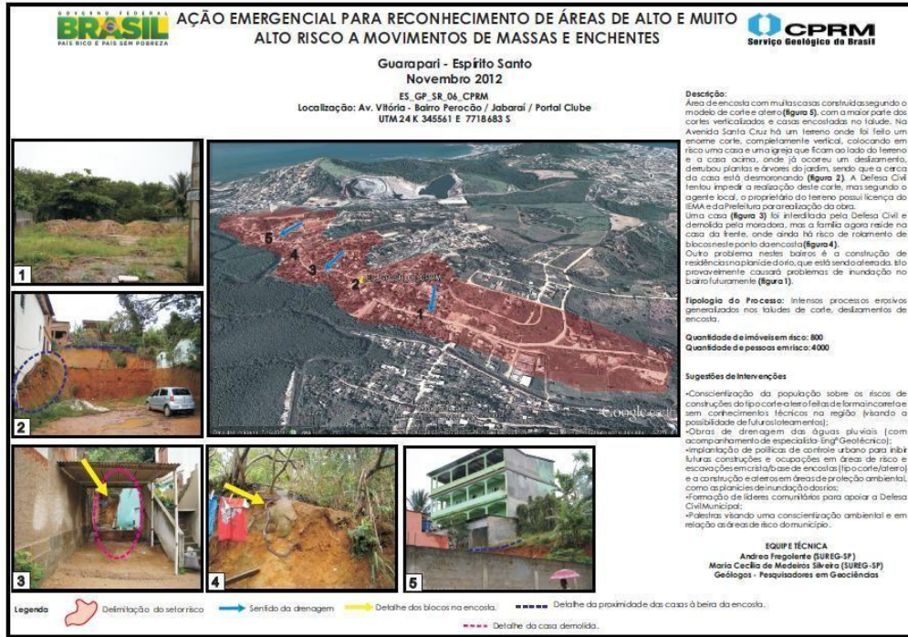
Figura 09: Setorização de área de risco geológico. Fonte: CPRM 2012
