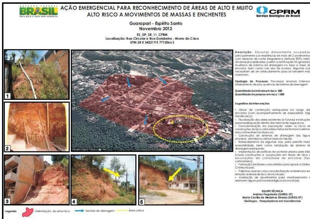
Figura 14: Setorização de área de risco geológico. Fonte: CPRM 2012
