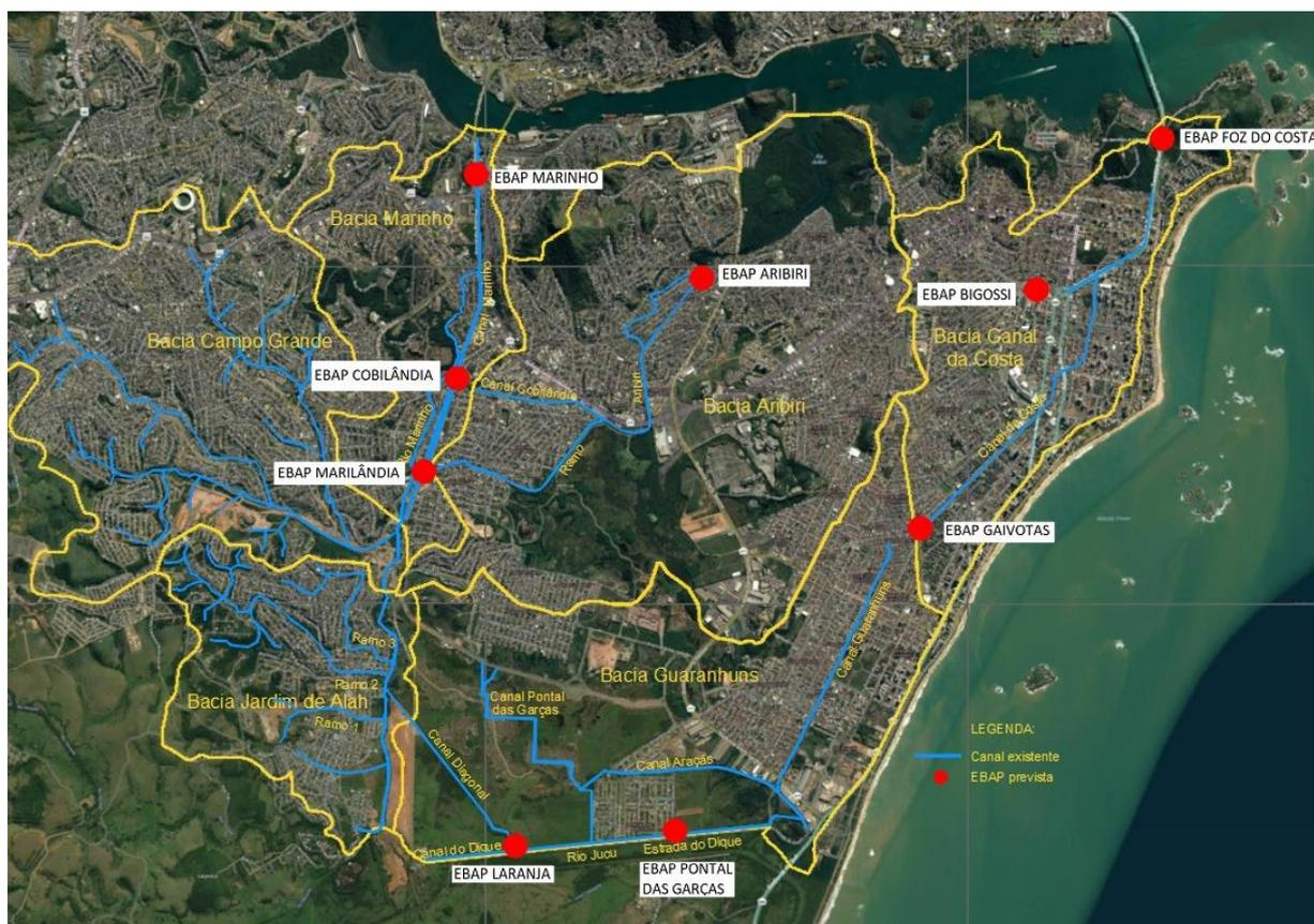
Figura 13: Estações de Bombeamento de Águas Pluviais (EBAP) projetadas. Fonte: SEDURB.
