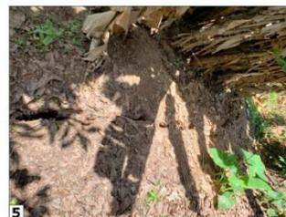
**Descrição:** Encosta de alta amplitude e declividade. Existe uma trinca no solo de grande proporção indicando que a encosta apresenta sinais de instabilidade e pode deslizar a qualquer momento.
