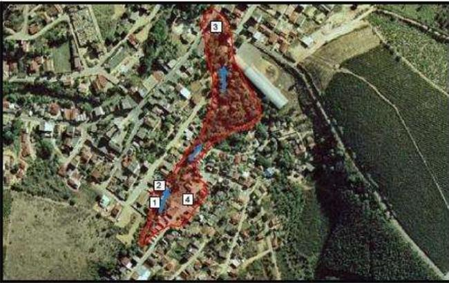
**Descrição:** Durante eventos de intensa pluviosidade ocorre o extravasamento das águas do canal do Rio Bananal (fotos 1 e 2), inundando parte do bairro São Sebastião (foto 4). Este canal, por ser mais estreito, sofre o represamento das suas águas pelo Rio Bananal (foto 3) que é um rio que possui maior vazão e causa o alagamento deste setor com danos materiais.
