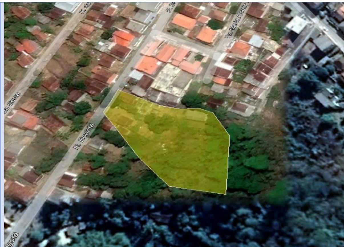
Descrição SR-28 - Yolanda: talude natural foi realizado diversos talude de corte, sem estruturação para ocupação residencial, sem qualquer obra de drenagem pluvial ou escoamento superficial, sem obras de contenção, risco de movimento de massa.
