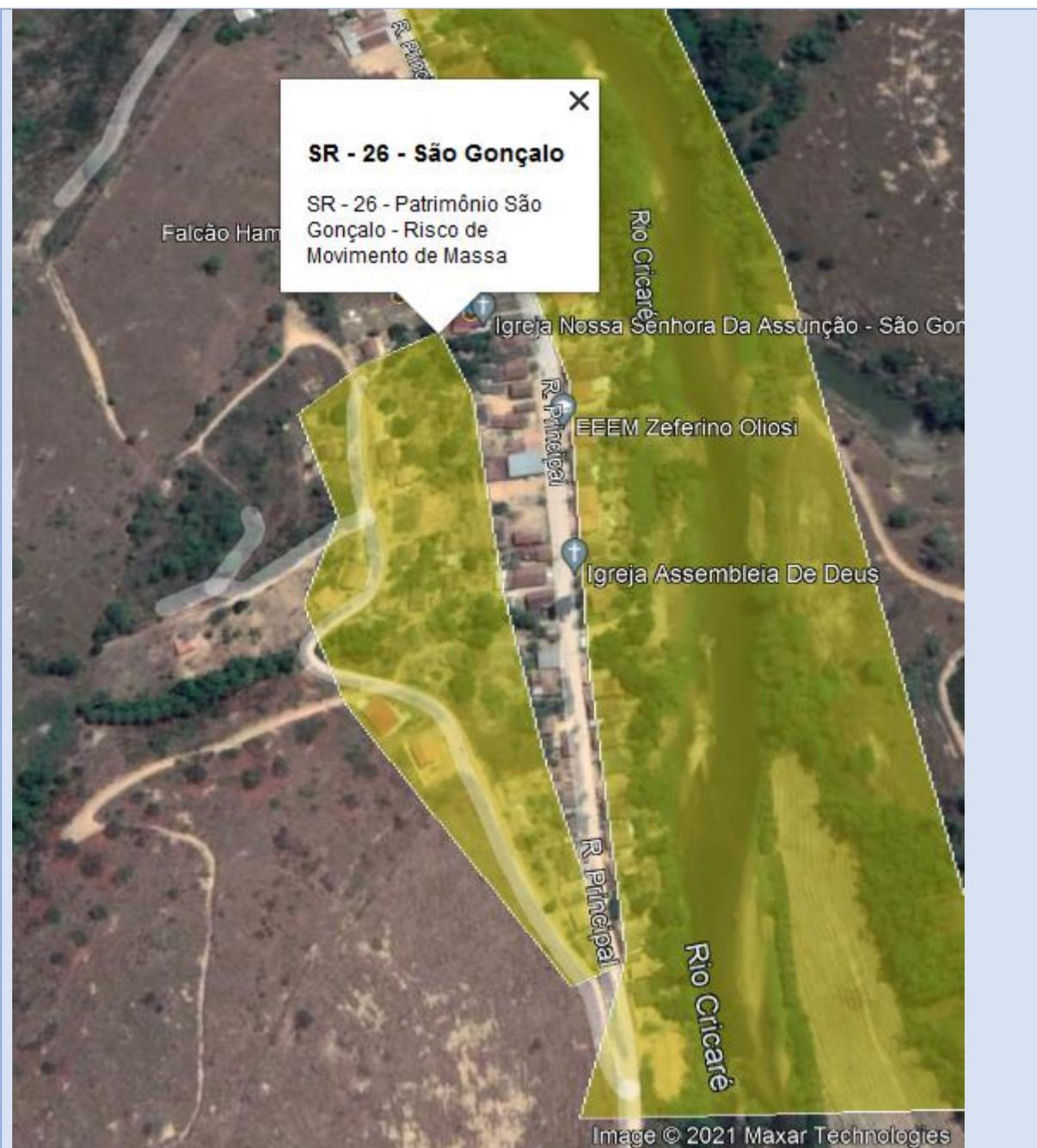
Descrição SR-26 - Patrimônio São Gonçalo – Zona Rural: talude natural foi realizado diversos talude de corte, sem estruturação para ocupação residencial, sem qualquer obra de drenagem pluvial ou escoamento superficial, sem obras de contenção, risco de movimento de massa.
