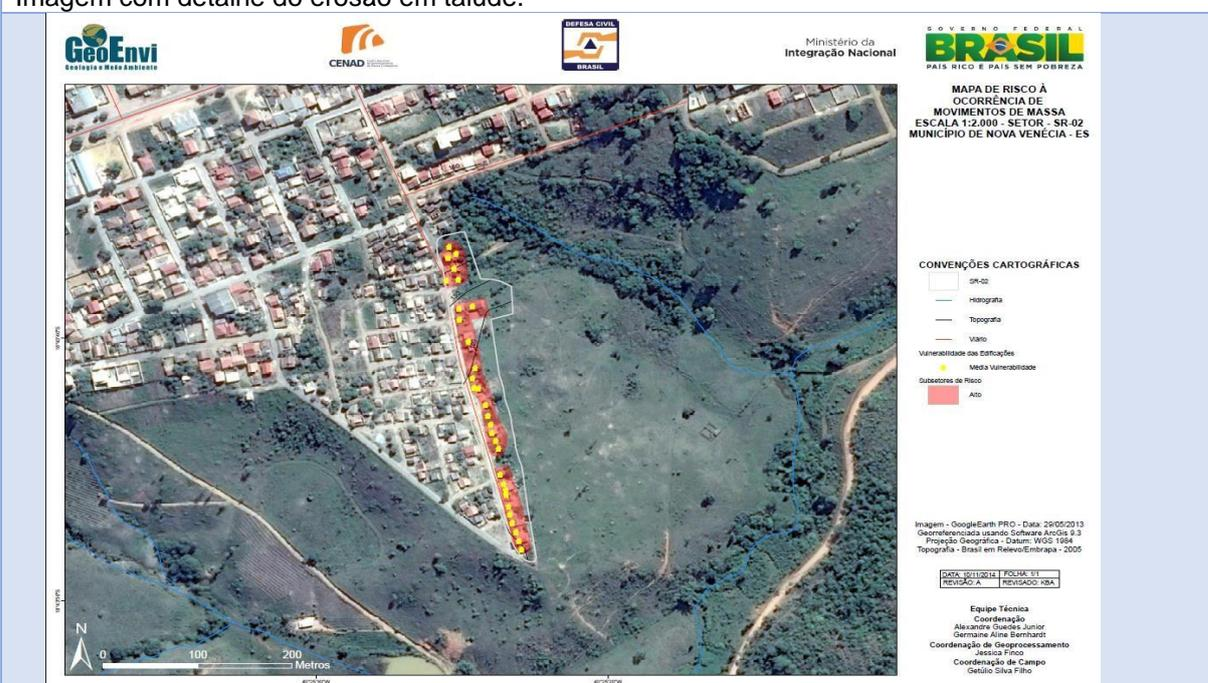
Descrição SR-02 – Bairro Alvorada: erosão superficial com perda de sustentação do talude e das moradias. Risco: movimentação de massa e enxurradas.
