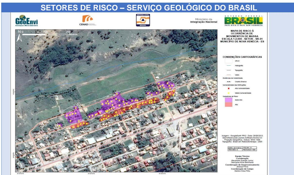
Descrição SR-01 - Bairro São Cristóvão: formação de ravinas e erosão acentuada em encostas de solo arenoargiloso, ocupado através de corte/aterro de taludes sem nenhum tipo de contenção ou obra de drenagem. Risco: movimentação de massas.
