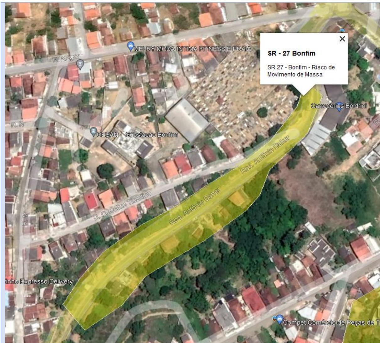
Descrição SR-27 - Bonfim: talude natural foi realizado diversos talude de corte, sem estruturação para ocupação residencial, sem qualquer obra de drenagem pluvial ou escoamento superficial, sem obras de contenção, risco de movimento de massa.
