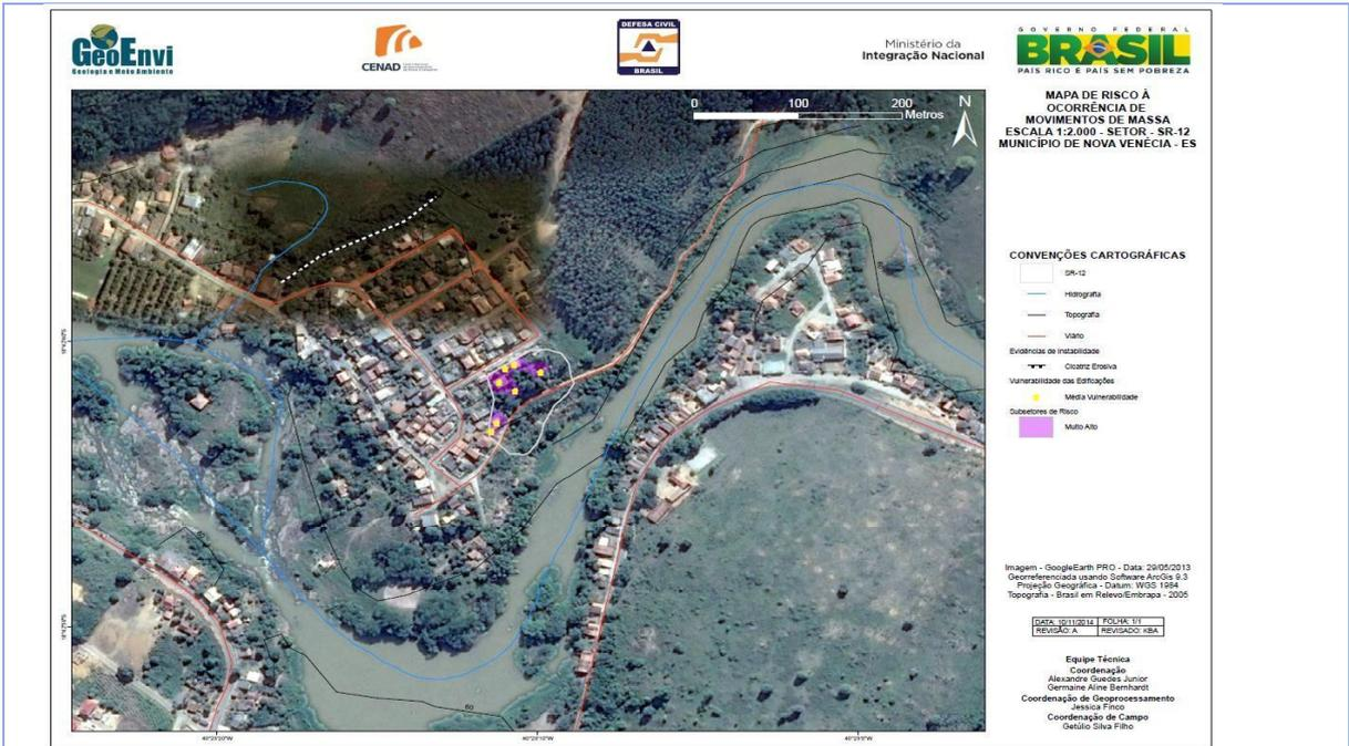
Descrição SR-12 - Bairro Fátima: erosão taludes de cortes subverticais, solo arenargiloso. Risco: movimento de massas.
