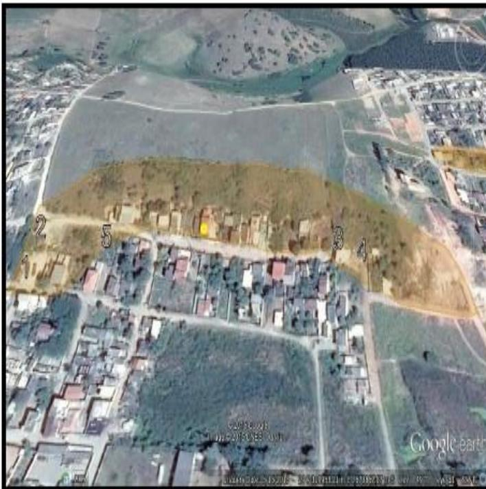
**Descrição:** Área de encosta de média amplitude e declividade ocupada por casas de médio/alto padrão em divanário, com risco induzido por cortes feitos de forma inadequada (Figuras 1 e 2), verticalizados (Figuras 3 e 5), desestabilizando o talude. Em um local, onde há um pequeno prédio, uma contenção de concreto projetado foi feita (Figura 4), também há indícios de muitos deslizamentos de pequena porte em vários cortes.
