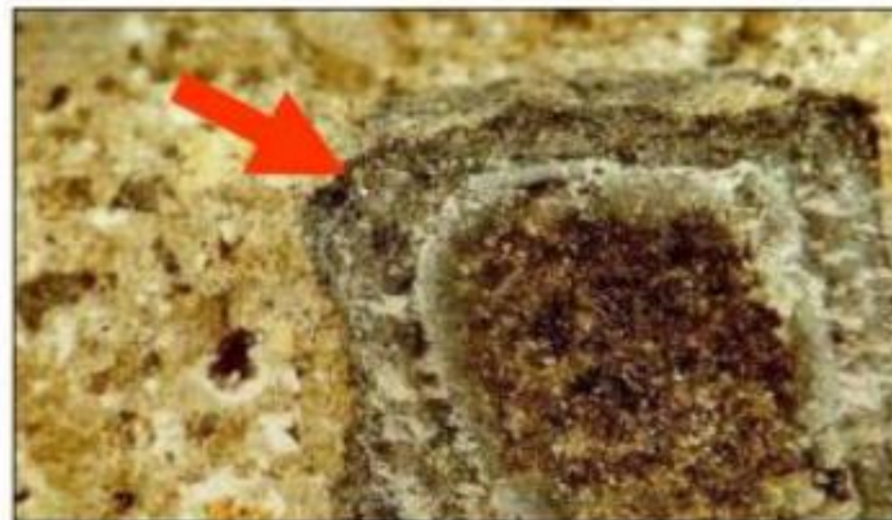
Gel na interface agregado/argamassa. Imagem microscopia óptica.
